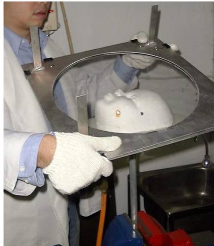
將矽膠材料加熱軟 化，真空成型
